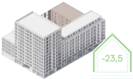
blok A constructieve wanden en vloeren in CLT excl. zandcement dekvloer
